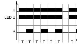
Включение напряжения питания U, начинает отсчёт установленного времени T. После отсчёта времени T, наступает срабатывание исполнительного реле R и снова начинается отсчёт времени T. Циклическая работа реле длится до момента выключения напряжения питания U.
